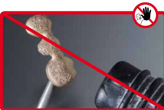
Konstrukci pečlivě opískujte \text{Al}_2\text{O}_3 (80–100 \mu\text{m} ) při tlaku 2–3 bar (29–44 psi) a oklepejte vhodným nástrojem.
