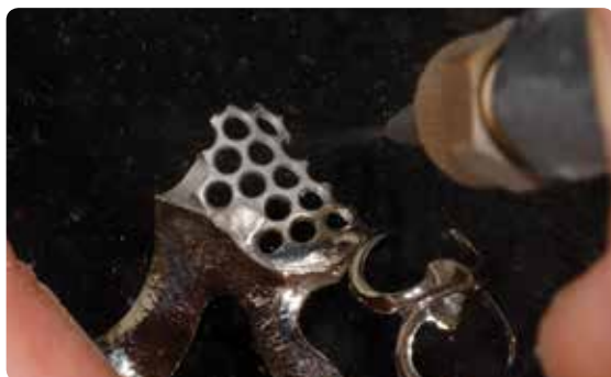
Opatrně opískujte oxidem hlinitým \text{Al}_2\text{O}_3 (80–100 \mu\text{m} ) při tlaku 3 bar (44 psi), poté odstraňte poklepáním vhodným nástrojem zbytky pískovacího prostředku.
