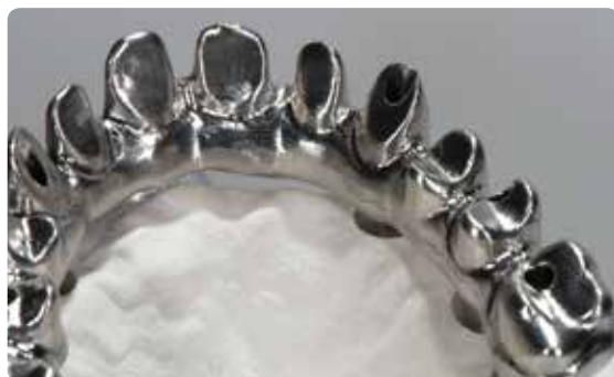
Hotová vyfrézovaná konstrukce.
