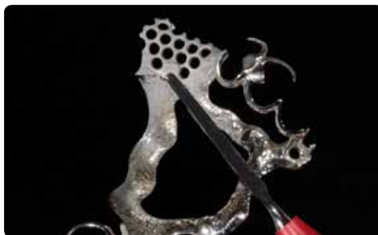
Opatrně opískujte oxidem hlinitým \text{Al}_2\text{O}_3 (80–100 \mu\text{m} ) při tlaku 3 bar (44 psi), poté odstraňte poklepáním vhodným nástrojem zbytky pískovacího prostředku.
