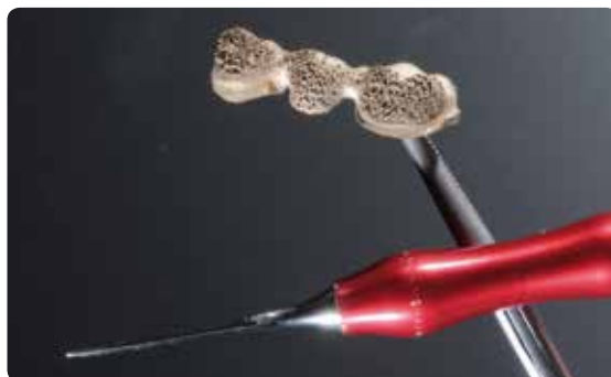
Konstrukci pečlivě opískujte \text{Al}_2\text{O}_3 (80–100 \mu\text{m} ) při tlaku 2–3 bar (29–44 psi) a oklepejte vhodným nástrojem.
