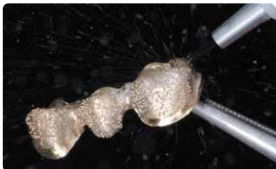
Konstrukci pečlivě opískujte \text{Al}_2\text{O}_3 (80–100 \mu\text{m} ) při tlaku 2–3 bar (29–44 psi) a oklepejte vhodným nástrojem.
